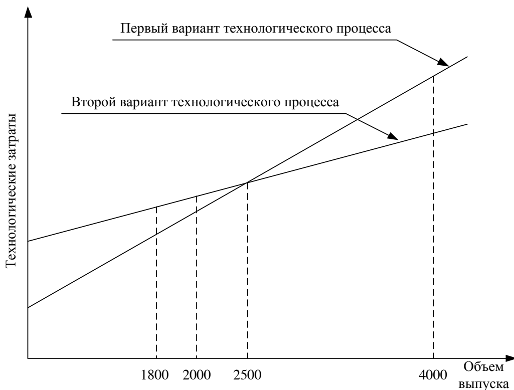
Рис.2.2. График сравнительной оценки двух вариантов технологического процесса
